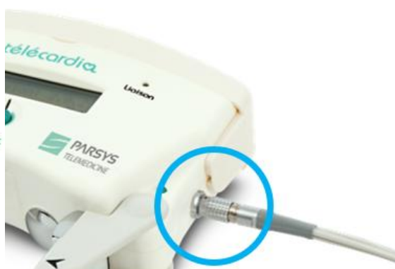
Raccordement du cordon Périphériques Le repère d'insertion, un point rouge sur le cordon, doit être tourné vers le haut de l'appareil
