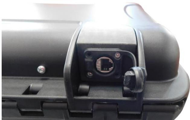
Insérer le connecteur RJ45 d'un câble Ethernet, raccordé au réseau Ethernet, dans la prise de la Station en respectant le sens d'insertion
