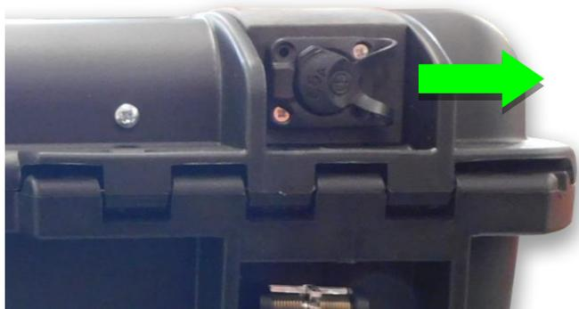
Ouvrir le capuchon de protection de la prise Ethernet (RJ45) en tirant dessus vers la droite
