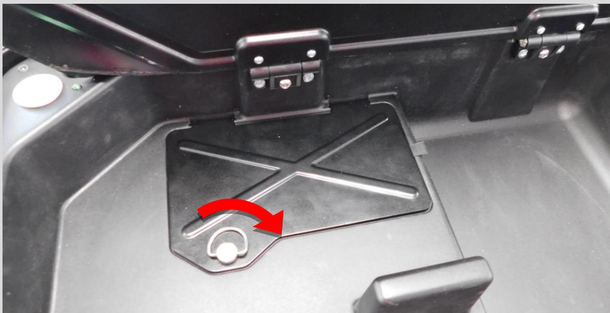
Une fois la batterie correctement positionnée, il convient de fermer la trappe et de **tourner d'un quart dans le sens inverse** la mollette de verrouillage.
