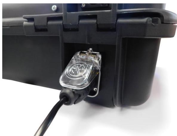
Vérifier que la sécurité mécanique du connecteur est bien déverrouillée avant d'extraire le connecteur en respectant les guides d'insertion/désinsertion de la prise sur la Station.
