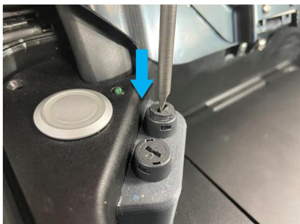
*Réinsertion et appui du capuchon avec son fusible*
