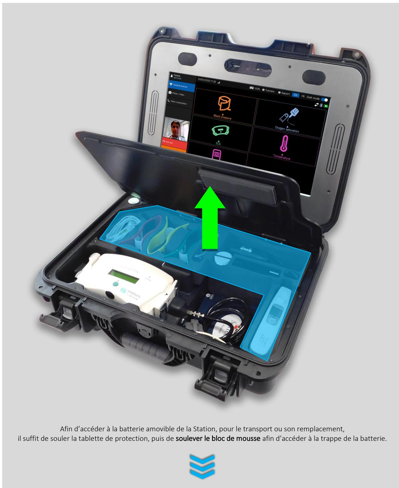
Afin d'accéder à la batterie amovible de la Station, pour le transport ou son remplacement, il suffit de soulever la tablette de protection, puis de **soulever le bloc de mousse** afin d'accéder à la trappe de la batterie.
