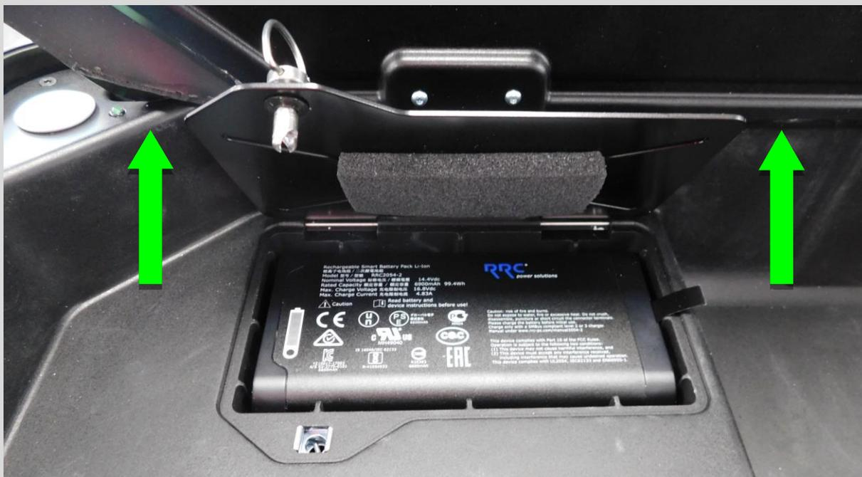
L'ouverture de la trappe permet d'accéder au bloc de batteries sécurisé et amovible.
