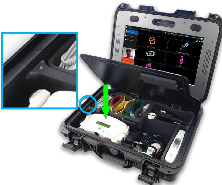
*Insertion de Télécardia dans son logement de recharge et position de l'indicateur de charge LED*
